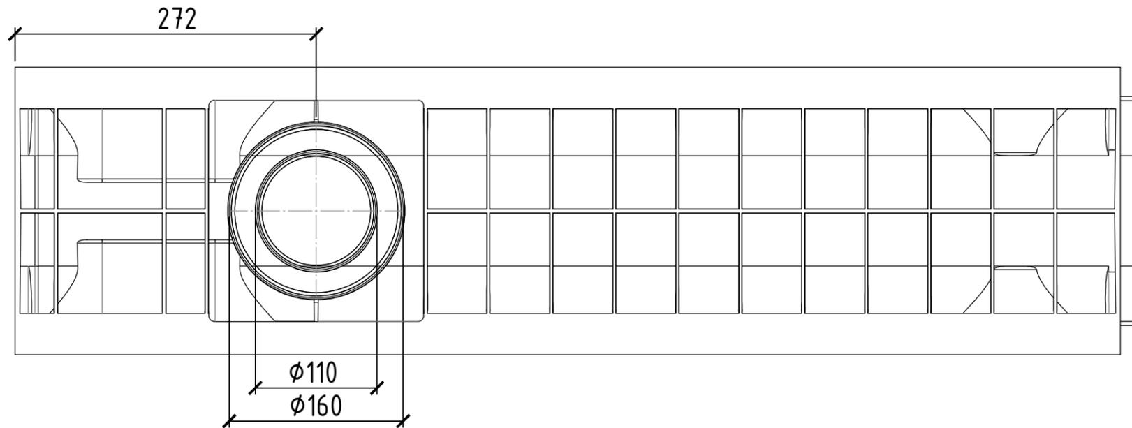
Лоток водоотводный пластиковый DN200 H185
